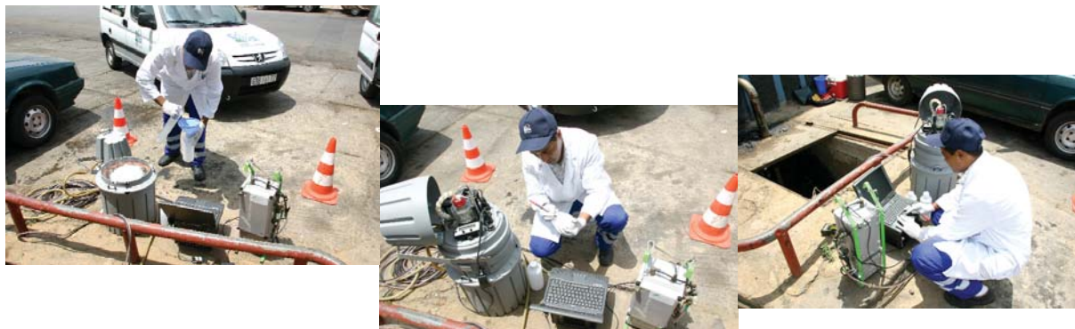
Agent LYDEC sur un chantier pour analyses des rejets liquides
